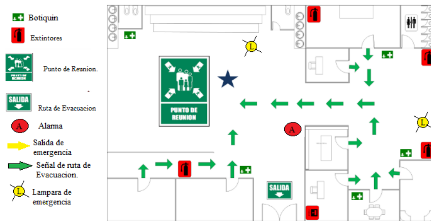
Figura 5. Señalética instalada en oficinas del primer piso.
