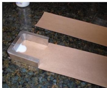
Figura 14 Aplicador con el que se extiende el adhesivo en el papel
