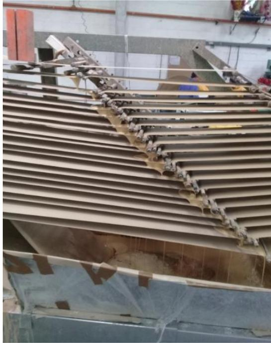
Figura 3 Se observa el proceso de aplicación de el adhesivo en las tiras de papel, a este método automático se conoce como cascada
