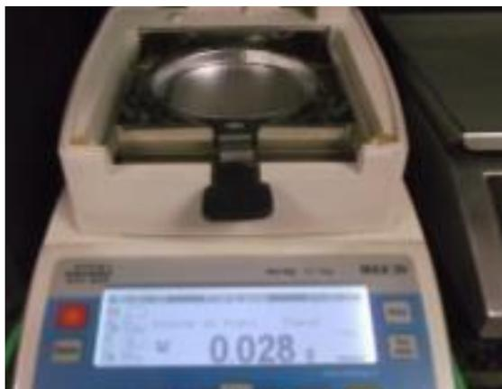
Figura 5 Se muestra la Termo Balanza con la que se realiza la prueba de validación de los adhesivos.
