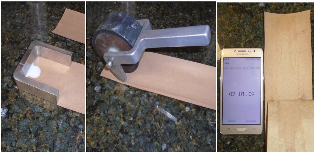
Figura 7 elementos que se ocupan para la prueba de pegado de izquierda a derecha, tira de papel con el aplicador, tiras de papel aplicando presión por medio de un rodillo, cronometro con el tiempo donde se detuvo la prueba al presentar desgarre el papel.
