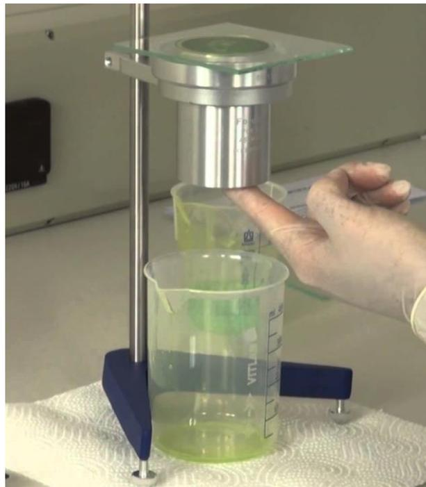
Figura 8 Como se debe colocar el equipo para realizar la prueba de verificación de la Viscosidad de los adhesivos
