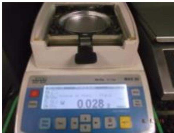
Figura 10 Tapa de termo balanza abierta para colocar charola
