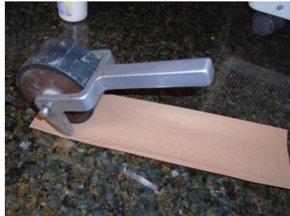
Figura 15 Rodillo con el que se aplica presión a las dos tiras
