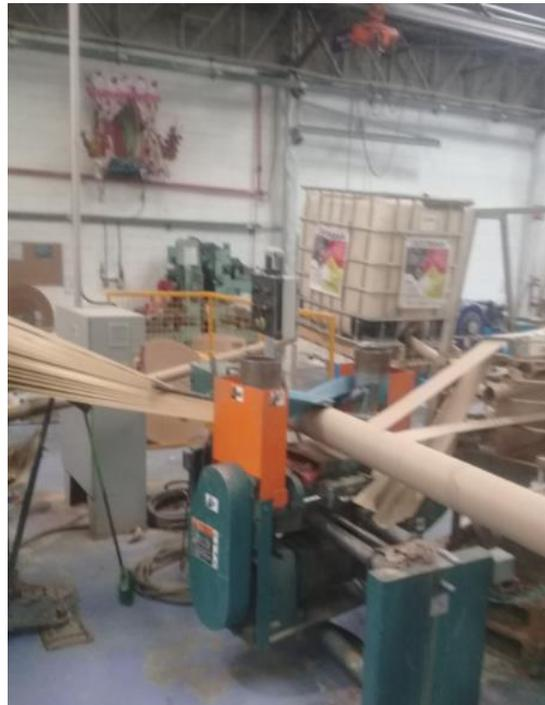
Figura 4 Se observa como es la maquina formadora de tubo de cartón estas se van uniendo después de aplicar el adhesivo
